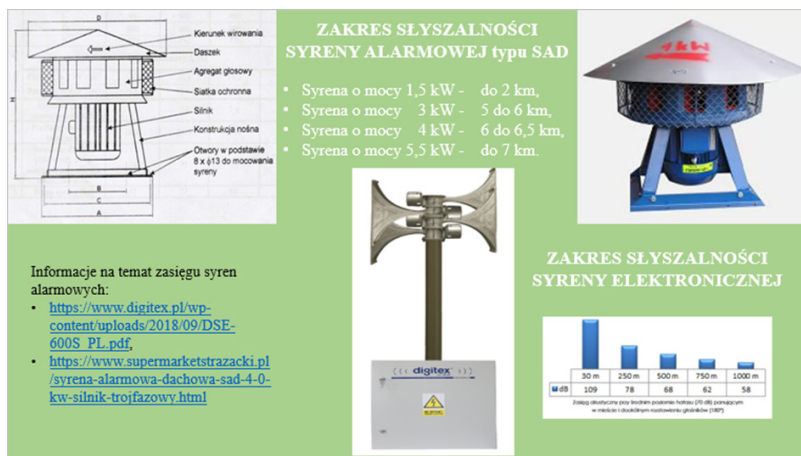
Rysunek 13. Zasięgi syren alarmowych mechanicznych i elektronicznych
