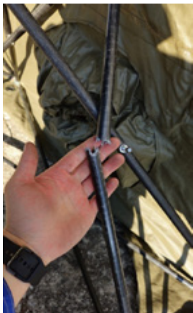
Ryc. 8. Uszkodzone rurki konstrukcyjne
