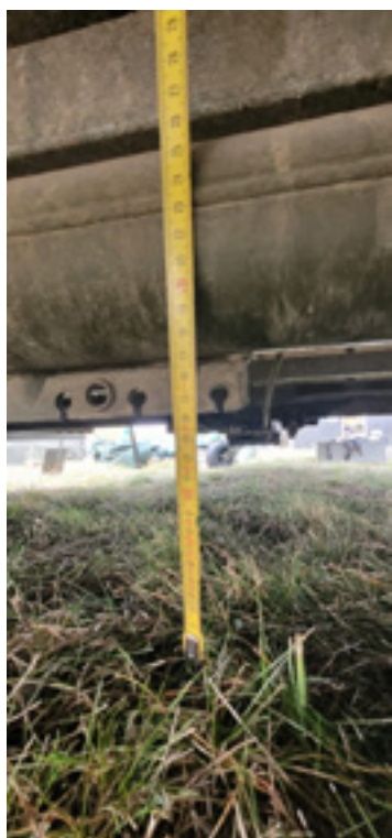
Ryc. 5. Zdjęcia rzeczywiste prześwitu przyczepy Źródło: Materiały własne.
